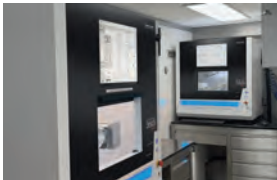
Abb. 1: Unsere beiden je 0,2 Tonnen schweren Fräsmaschinen mit je einem Platzbedarf von 0,6m 2 .
