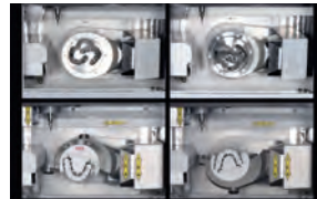
Abb. 3: Simultan-fräsen in zwei Maschinen. 1 x Nassfräsung Titan und 1 x Trockenfräsung Zirkon
