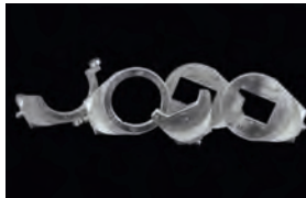
Abb. 2: Aufnahmen für alle auf dem Markt befindlichen Fräswerkstoffe
