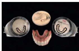
Abb. 11: Verblendungen aus der Fräsmaschine
