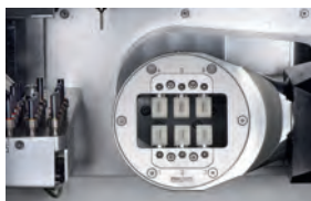
Abb. 13: Schleifen von Feldspatkeramik
