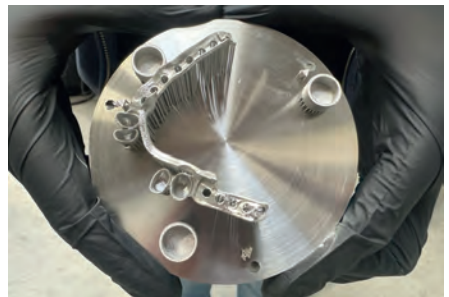
Abb. 2: Bauplattform nach dem Lasern
