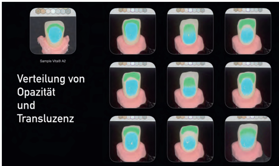
Abb. 2: Multilayerzirkonoxid in A2 - Farbunterschiede der verschiedenen Produkte
