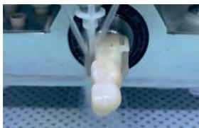
Abb. 13: Schleifvorgang einer dreigliedrigen Brücke mit der EASYMill 4 Schleifinheit aus Perfit FS ML-Brückenrohling.
