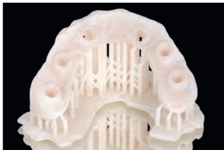
Abb. 4: 3D-gedruckte Versorgung aus einem nanokeramischen Hybridmaterial unter Verwendung der Digital Light Processing (DLP)-Technologie. Materialien mit verbesserten Eigenschaften erweitern das Indikationsspektrum für permanente Versorgungen.
