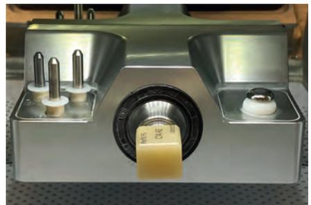
Abb. 3: Der Werkzeugwechsel erfolgt mittels eines pneumatischen Spannsystems, die Länge der Werkzeuge wird automatisch am Tastknopf gemessen.
