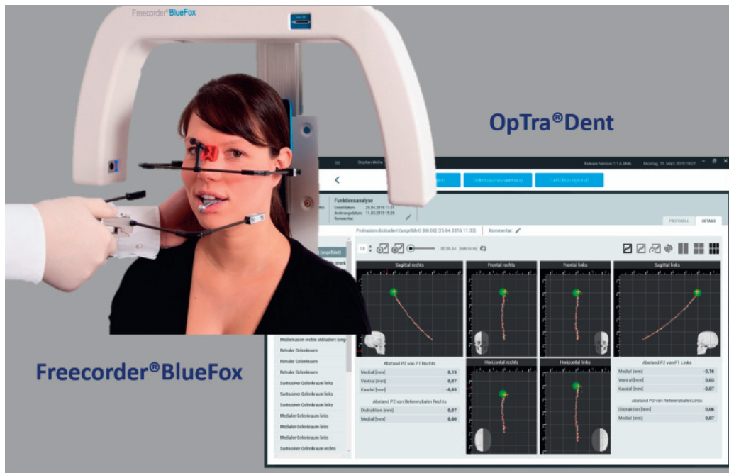
Abb. 2: Optoelektronisches Registriersystem zur Bewegungserfassung und Gelenkraumvermessung
