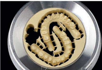
Abb. 7: Die aus einer PEEK-Ronde herausgeschliffenen Tertiärstrukturen werden identisch konstruiert. Sie bilden die Basis zweier praktisch identischer OK-Prothesen.
