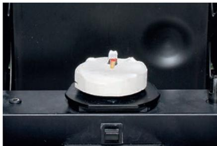
Abb. 7: Es geht auch ohne einen taktilen Scanner. Beschichtetes Primärteil im Scanner.
