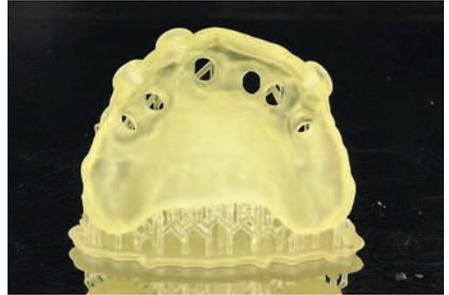
Abb. 4: Gedruckte Bohrschablone vor der Endhärtung
