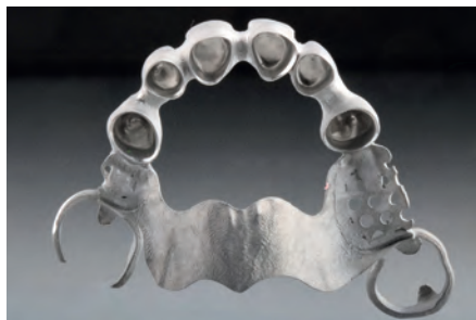
Abb. 2: Im CAD/CAM-Hybrid-Verfahren gefertigte Einstück-Konstruktion Kombination aus Sekundärteleskopen mit Modellguss
