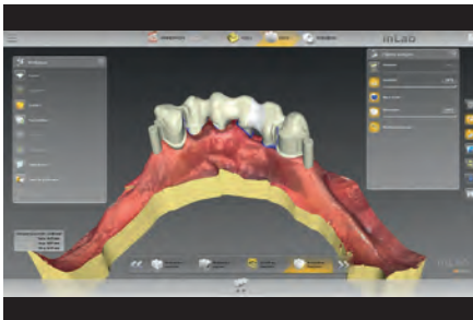
Abb. 3: Geschiebearbeit mit Intraoralscan und gemischten analog/digitalen Arbeitsabläufen
