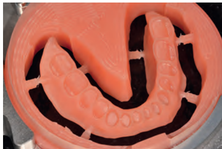
Abb. 2: Ausfräsen der Prothesenbasis aus einem Polymethylmethacrylatröhring
