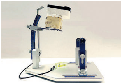
Abb. 6: FastLink®-Montagetisch zur schmierachsgerichten Positionierung des UK-Modells im Unterteil eines Arcon-Artikulators
