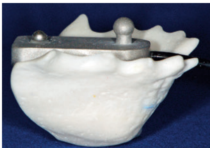
Abb. 5: Messschablone OK mit Messgeber
