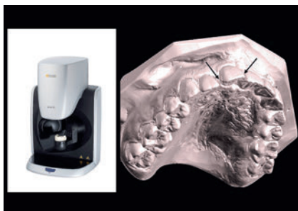
Abb. 1: Der fünfachsige Scanner mit Roboterarm scannt auch in Problemsituationen hervorragend
