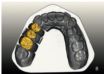
Abb. 7 und 8: Die statische und dynamische Okklusion wurde mit dem virtuellen Artikulator in schädelbezoglicher Ausrichtung kontrolliert und virtuell „eingeschliffen“.
