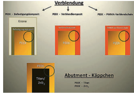
Abb. 2: Mögliche Verbundvarianten von PEEK
