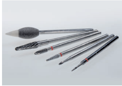
Abb. 11: Das Ausarbeitungsset zur Bearbeitung der im Weißlingszustand gefrästen Brücke, welches aus verschiedenen kreuzverzahnten Fräsen und einem Spezialgummierer (Komet, Gebr. Brasseler, Lemgo) zur Bearbeitung von Zirkonoxid besteht.
