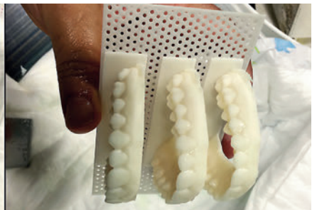
Abb. 7: Gedruckte Modelle auf dem Druckerhalter
