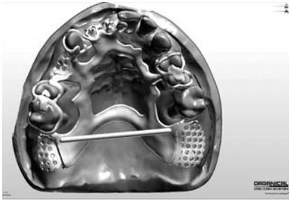
Die Modellation verläuft genau so intuitiv wie bei der 3Shape Kronen- und Brückensoftware. Das 3Shape Modellguss Design Modul ist dem Dental Designer angeglichen und ermöglicht ein schnelles intuitives Arbeiten. Die Gesamtkonstruktion wird zum Schluss als Datensatz an den Drucker exportiert.
