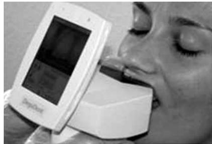
Abb.4: Shadepilot, Messung der gesamten Zahnoberfläche
