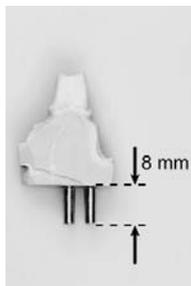
Abb. 2: herkömmliches Modell-Segment mit kurzen Pins, die wegen ihres ungünstigen Hebels zu weiteren Ungenauigkeiten führen können
