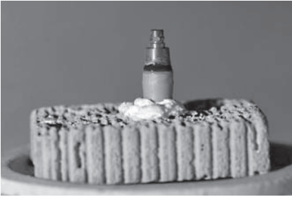
Das mit Hotbond fixierte Abutment wird nach dem Brand langsam abgekühlt
