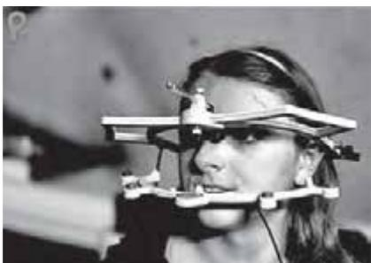
Abb. 4a: elektronische Bewegungsanalyse (zebris, Schütz Dental)
