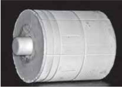
9. Muffeloberfläche: Die Oberfläche der Muffel bei Einsatz eines Silikon-Muffelformers erzeugt eine vergrößerte Oberfläche. In der Theorie geht man davon aus, dass die Wärmestrahlung der Heizspirale so besser die Muffel aufheizen kann. In der Praxis stellt sich dieser Faktor in seinem Einfluss als gering heraus, die Wärmeleitfähigkeit der Einbettmasse ist bedeutsamer für das Gesamtergebnis.
