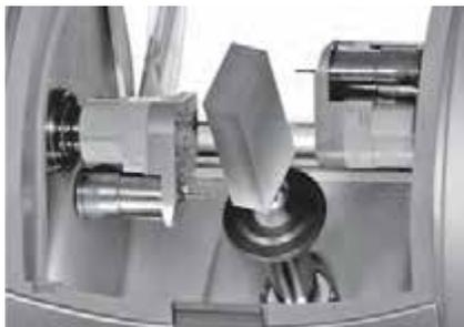
Abb. 2: In der Nassschleifkammer: Die Formgebung erfolgt in der Maschine inLab MC XL. – Foto: DeguDent
