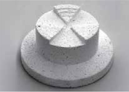
5. Presstisch: Der optimierte Presstisch des DEKE-MA-Brennofens trägt den neuesten Erkenntnissen der Temperaturverteilung in der Brennkammer keramischer Brennöfen Rechnung und erlaubt aufgrund seiner speziellen punktuellen Auflagefläche eine Zirkulation der Strahlungswärme in der Brennkammer. Dies führt zu einer gleichmäßigeren Temperaturverteilung innerhalb der Muffel und trägt zu qualitativ besseren Ergebnissen bei.
