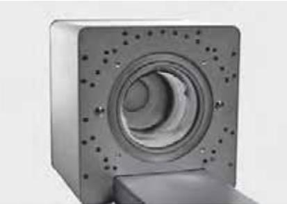
7. Heizelement alt: Ein verbrauchtes Heizelement ist zur Erzielung qualitativ hochwertiger Ergebnisse kontraproduktiv. Eine exakte Temperatursteuerung ist unabhängig vom verwendeten Ofentyp/Hersteller nicht gewährleistet.
